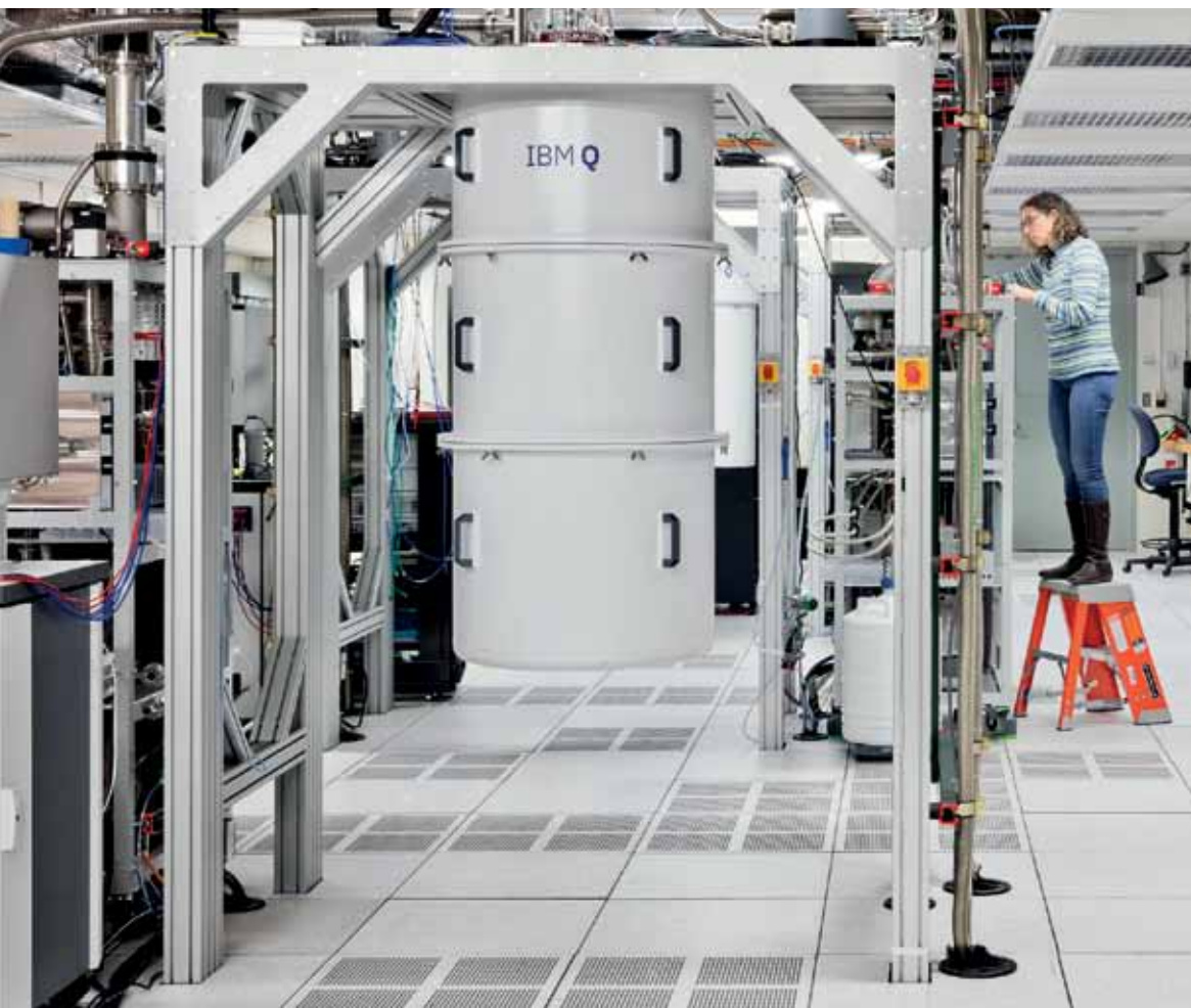
Montagem do IBM Q System One, que ocupa uma área de 9 metros quadrados
