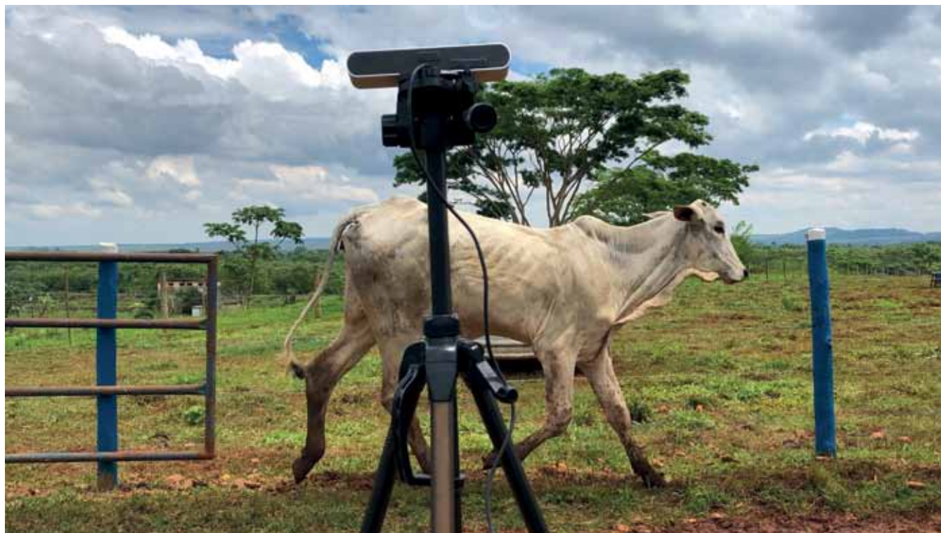
Câmera desenvolvida pela startup Olho do Dono faz a pesagem do animal em movimento em qualquer lugar da fazenda
