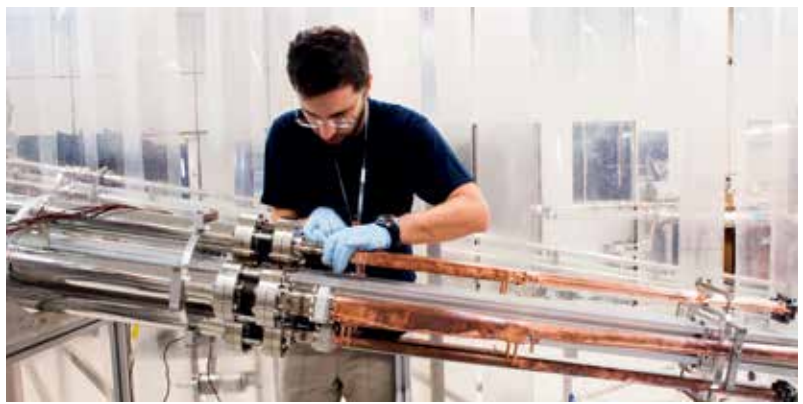
L'ingénieur Rafael Seraphim mène des tests sur le système sous vide des cavités qui conduiront les électrons. Ci-contre, des aimants quadruples, l'un des composants de l'anneau de stockage
