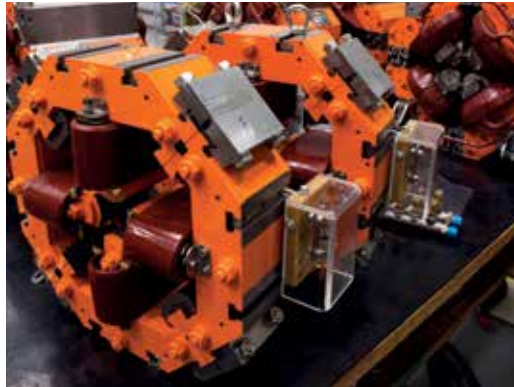
L'ingénieur Rafael Seraphim mène des tests sur le système sous vide des cavités qui conduiront les électrons. Ci-contre, des aimants quadruples, l'un des composants de l'anneau de stockage
