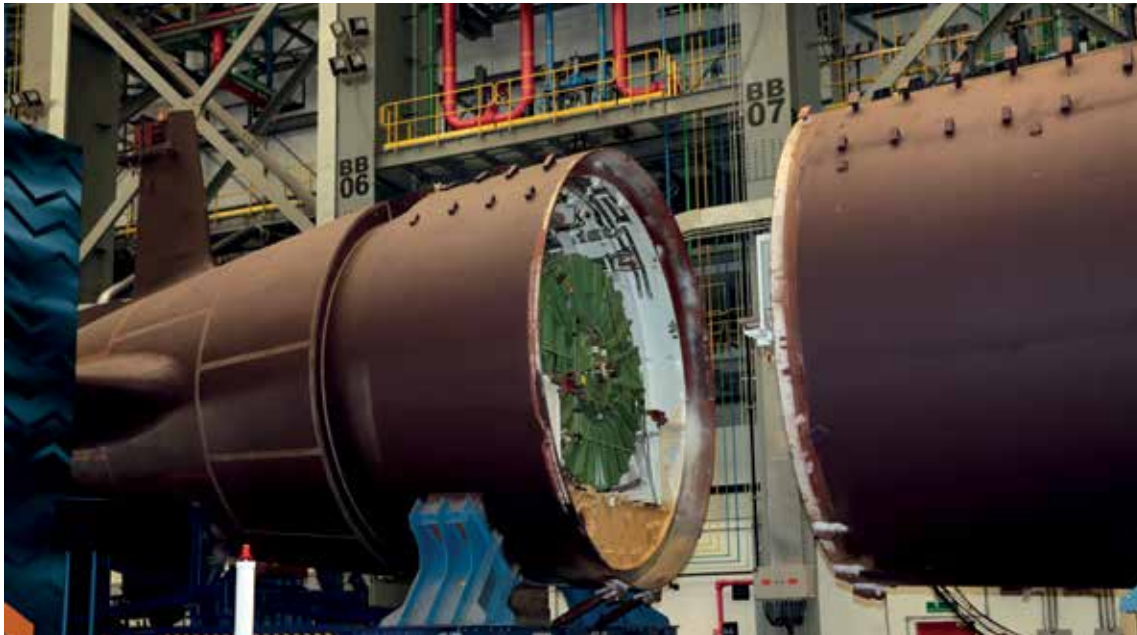
Montage des deux parties du Riachuelo, à la base navale d'Itaguaí (RJ)
