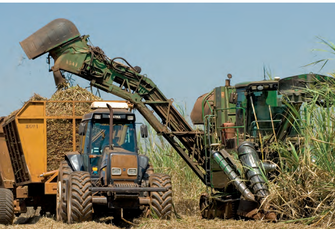
Colheitadeira de cana no interior paulista: o colmo é armazenado no caminhão enquanto a palha é lançada de volta ao campo
