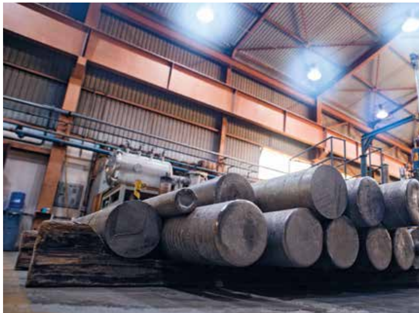
Lingotes de niobio metálico de la Escuela de Ingeniería de Lorena de la USP
