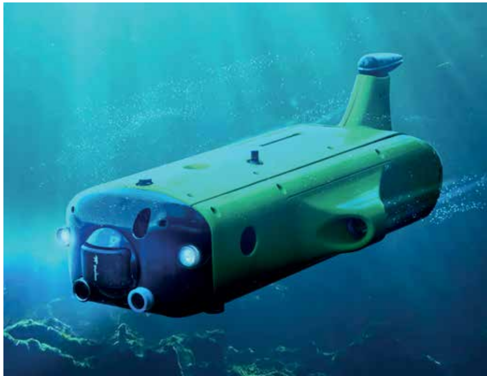
Robô submarino autônomo Flatfish, para inspeção visual de dutos de petróleo: caso de sucesso
