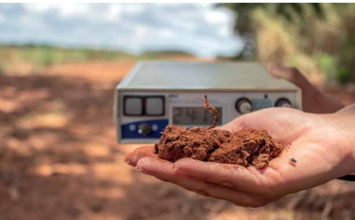
Em sentido horário: análise da composição do solo por fluorescência de raios X; amostras com diferentes concentrações de ferro; leitura de magnetismo do solo com uso de susceptíbilímetros
