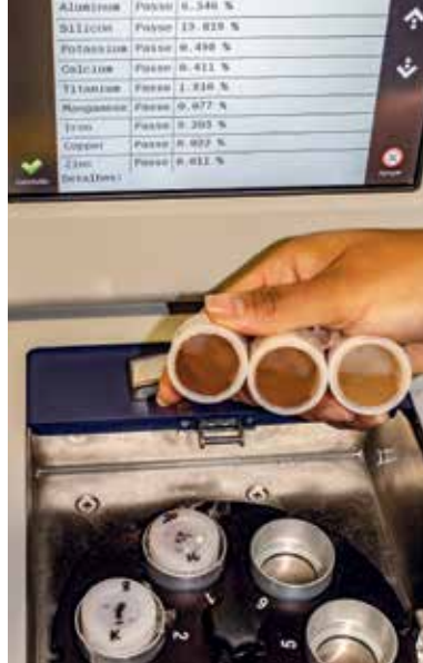
Em sentido horário: análise da composição do solo por fluorescência de raios X; amostras com diferentes concentrações de ferro; leitura de magnetismo do solo com uso de susceptíbilímetros
