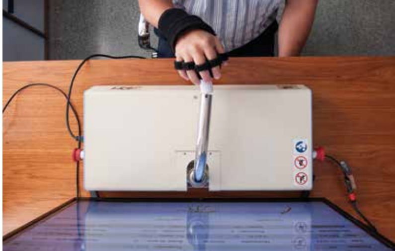
O robô portátil da Vivax, com formato similar ao de um joystick, apoia a reabilitação de membros superiores
