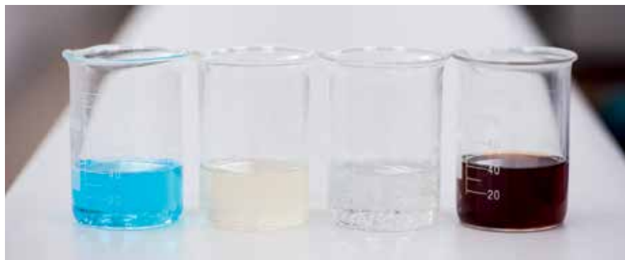
Etapas da síntese de fabricação de nanocobre no IPT: solução de sulfato de cobre penta-hidratado, agente de revestimento, agente redutor e solução líquida de nanopartícula de cobre (da esq. para a dir.)
