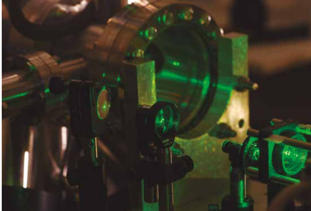
Janela traseira da câmara usada para deixar passar a luz que se deseja coletar
