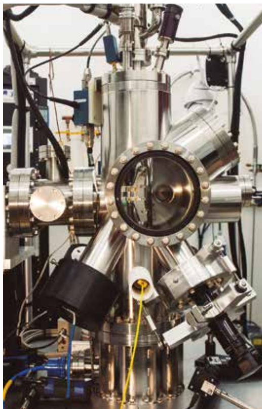
Microscópio de varredura de tunelamento do IFGW da Unicamp (à esq.) e detalhe de sua câmara de ultra-alto-vácuo (página ao lado)
