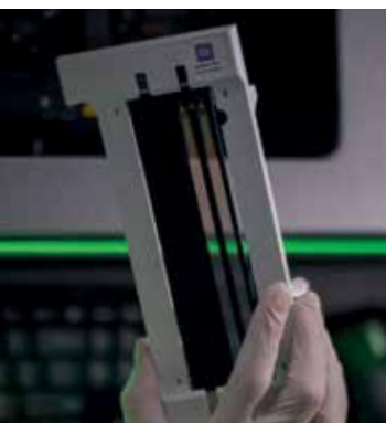
Máquinas de sequenciamento: flow cell na qual as amostras são inseridas na Illumina NovaSeq ( abaixo ); no método Sanger, o DNA passa por finos fios ( à dir. )
