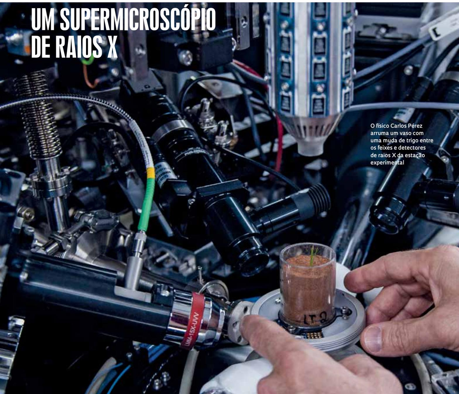
O físico Carlos Pérez arruma um vaso com uma muda de trigo entre os feixes e detectores de raios X da estação experimental
