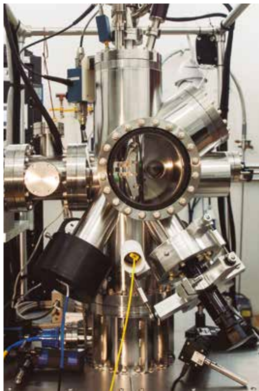
Microscope à effet tunnel de l'IFGW de l'Unicamp (à gauche) et détail de sa chambre à ultravide (page à côté)
