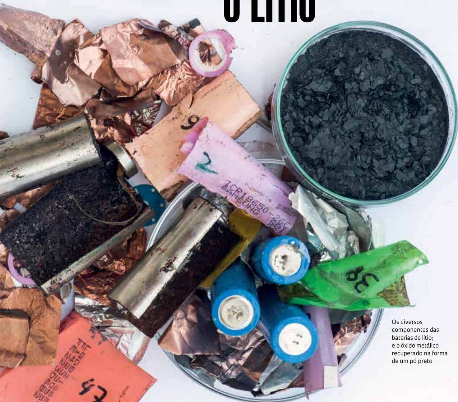
Os diversos componentes das baterias de lítio; e o óxido metálico recuperado na forma de um pó preto
