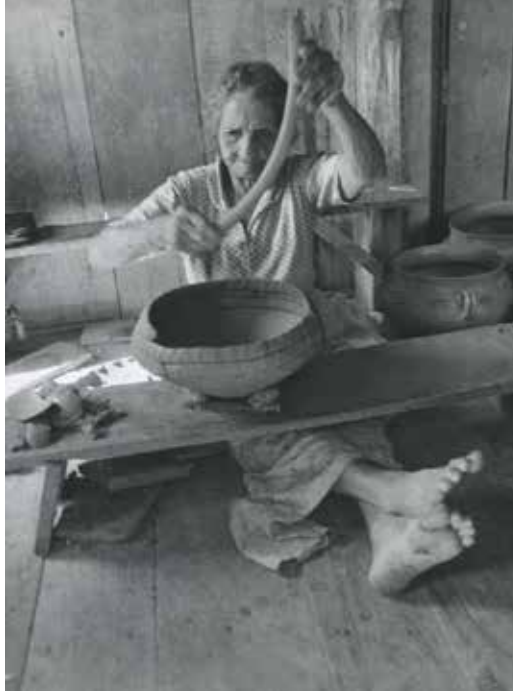
Na década de 1970, ceramista de Iguape (SP) executa peça com a técnica de acordelado, legado Tupiniquim do período colonial
