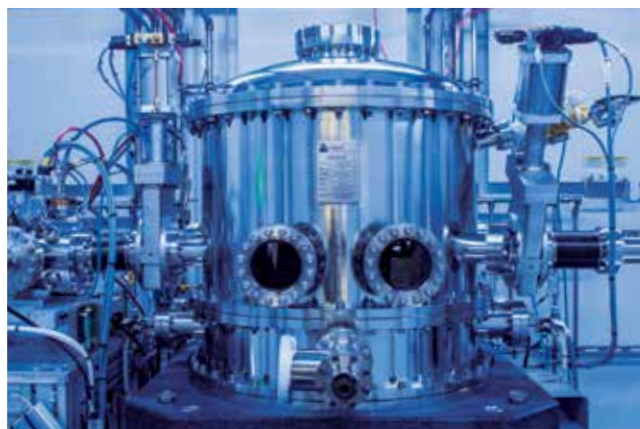
Monocromador: un dispositivo que forma parte de la línea de luz Carnaúba del Sirius, donde se llevó a cabo el estudio
