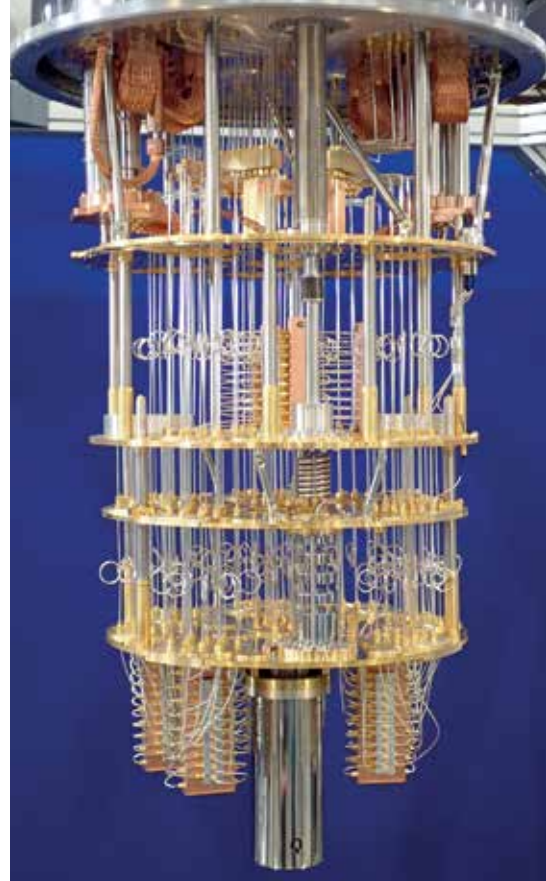
Interior de um processador quântico desenvolvido pela IBM
