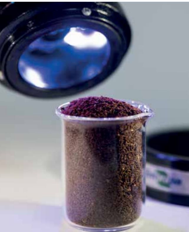
Microscópio digital do CoffeeClass, sistema capaz de reconhecer defeitos em grãos torrados e moídos, desenvolvido na Embrapa Instrumentação
