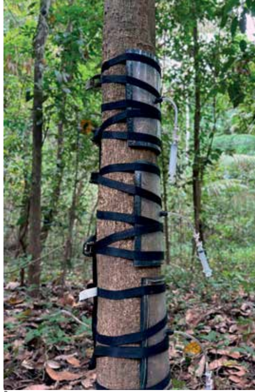
Aparatos presos às árvores, em várias alturas, permitiram medir as trocas gasosas
