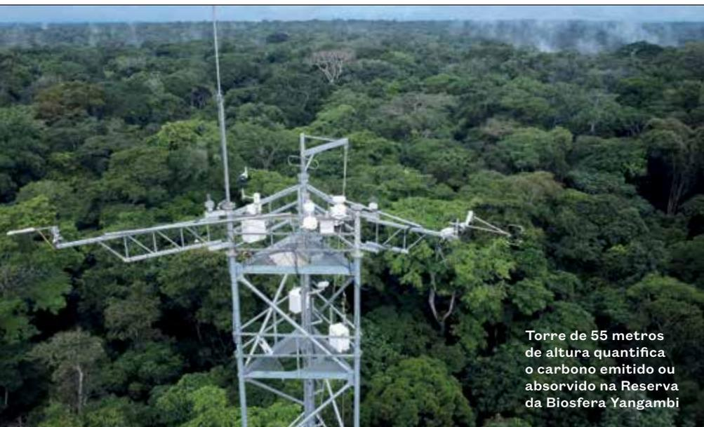
Torre de 55 metros de altura quantifica o carbono emitido ou absorvido na Reserva da Biosfera Yangambi
