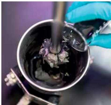
Ao lado, preparo de pasta de cimento com material contendo grafeno; mais à esquerda, grafeno em pó (atrás) e composto aditivado à base de termoplástico e do nanomaterial
