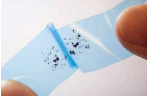
Esfoliação de grafite com fita adesiva (à esq.), solução com grafeno manipulada por pesquisador da UFMG (abaixo, à esq.) e recipientes com diferentes tipos de grafite e do nanomaterial
