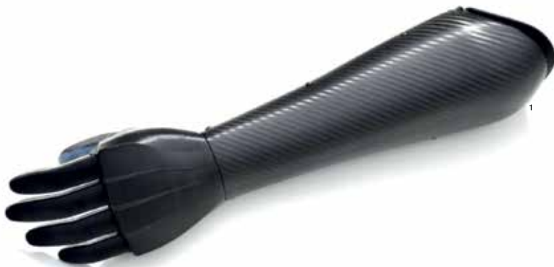
Protótipo de prótese transradial destinada a pessoas que sofreram amputação no braço
