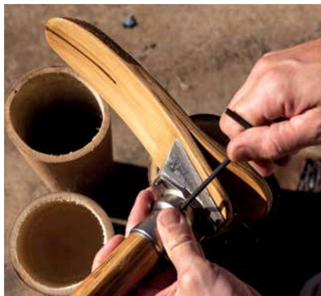
Prótese transtibial (à dir. e na página ao lado) feita a partir de fibras de bambu e resina de mamona
