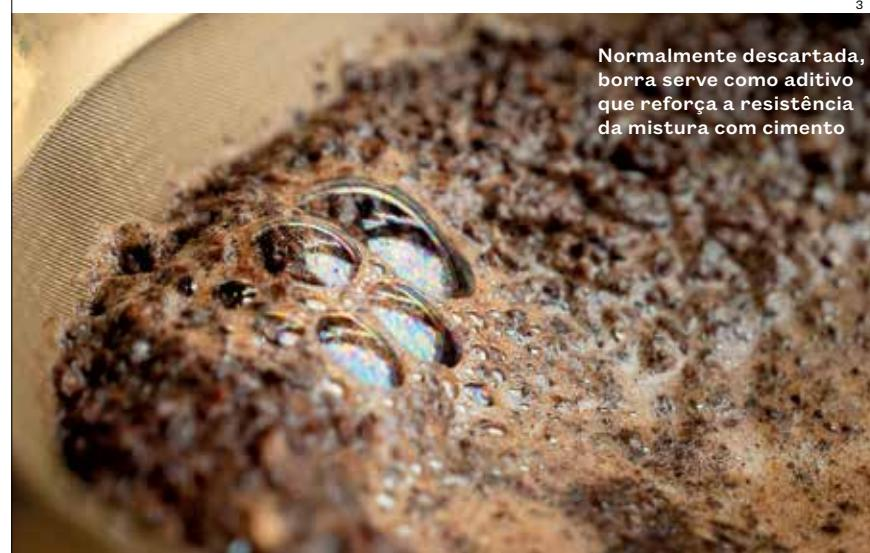
Normalmente descartada, borra serve como aditivo que reforça a resistência da mistura com cimento
