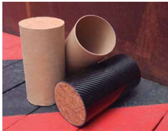
1 Tubo vazio de papelão, com taipa confinada e com cobertura de polímero reforçado com fibra de carbono
