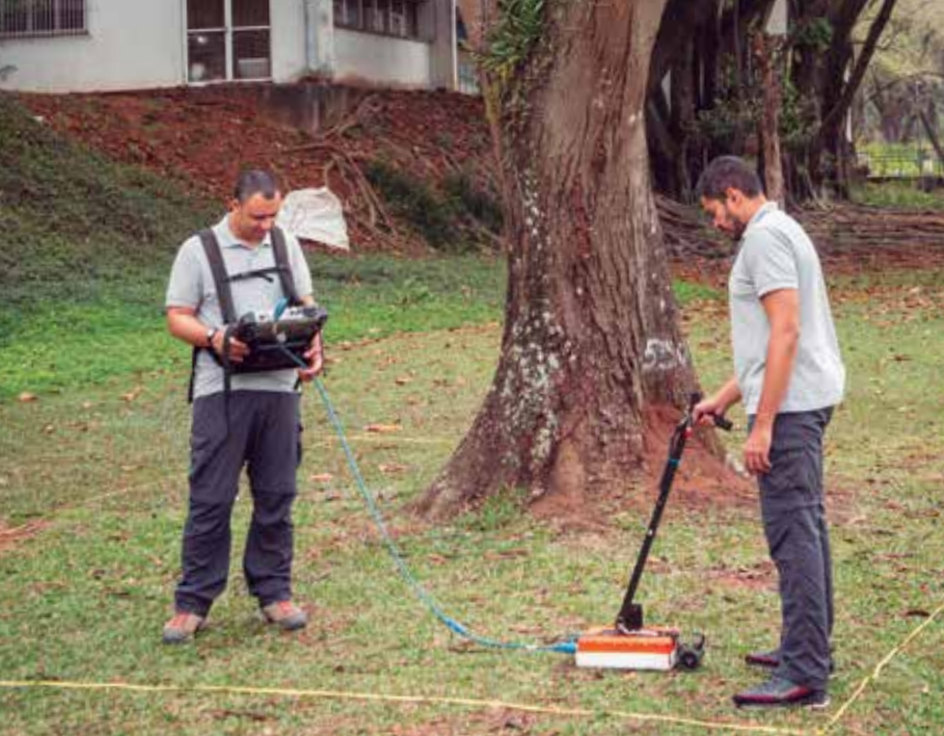
Técnicos fazem mapa 3D das raízes sem escavar o terreno usando a tecnologia Kerno Andas
