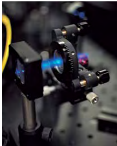
Feixes de laser das microlentes produzidas por impressão 3D, moldagem em silicone e resina transparente
