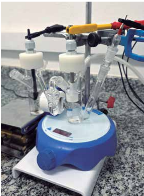
Reator usado para converter nitrato em amônia renovável
