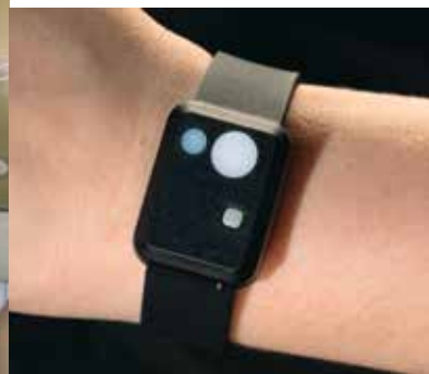
Astronautas da missão levaram em seu pulso um actígrafo desenvolvido no Brasil, dispositivo na forma de um relógio que mede funções vitais
