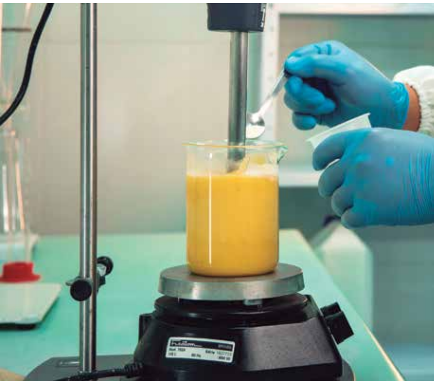
Aplicação do Microcap sob agitação em processo de fabricação de um creme. Ao lado, imagem de microscopia eletrônica de varredura mostra a morfologia de partículas da nova formulação
