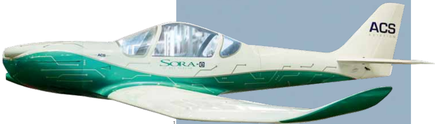
1 Acima, o protótipo do Sora-e. O avião movido a eletricidade foi baseado no Sora com motor a combustão, ao lado
