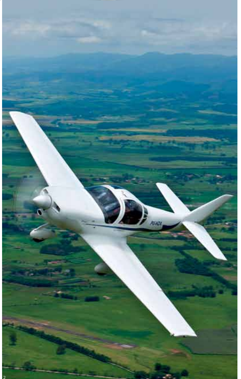
1 Acima, o protótipo do Sora-e. O avião movido a eletricidade foi baseado no Sora com motor a combustão, ao lado
