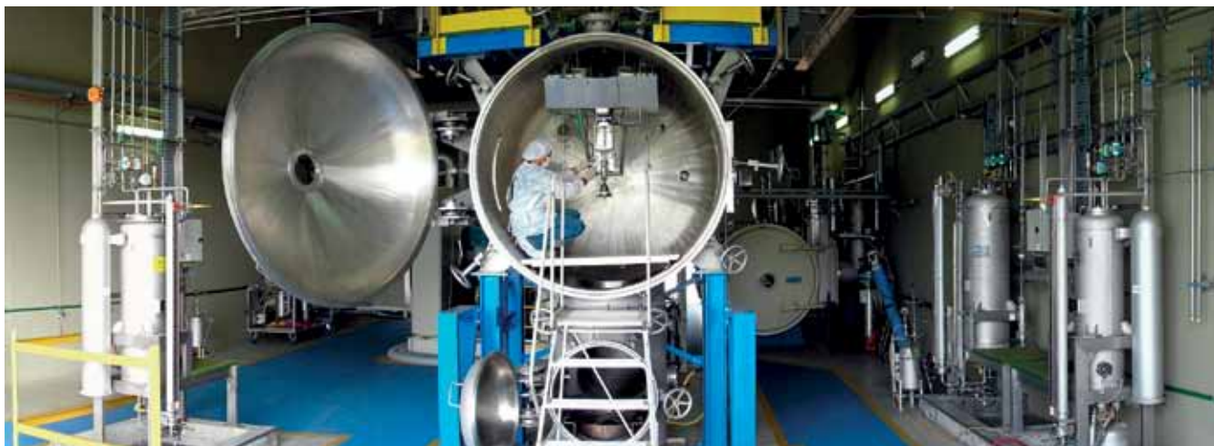
Bancada de testes de motores no IAE, em São José dos Campos
